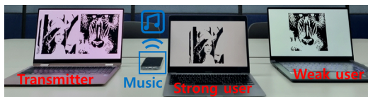
그림 15. 잡음을 추가한 환경에서 음파통신 테스트베드 송신단 및 수신단 Fig. 15. Transmitter and receiver of acoustic communication testbed
